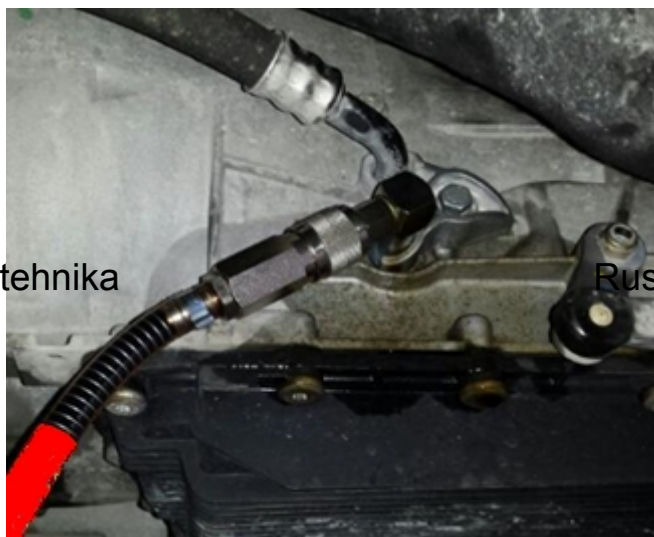
Рис 20 – Подключение красного шланга
