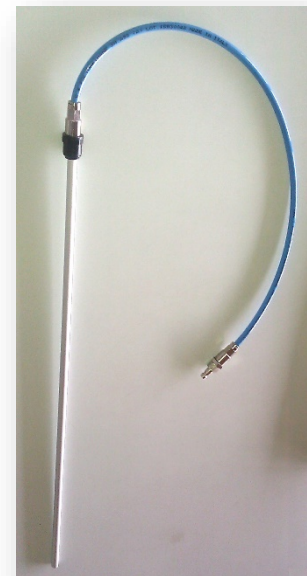
Figura 13 - Tubo "X" per scarico olio esausto
