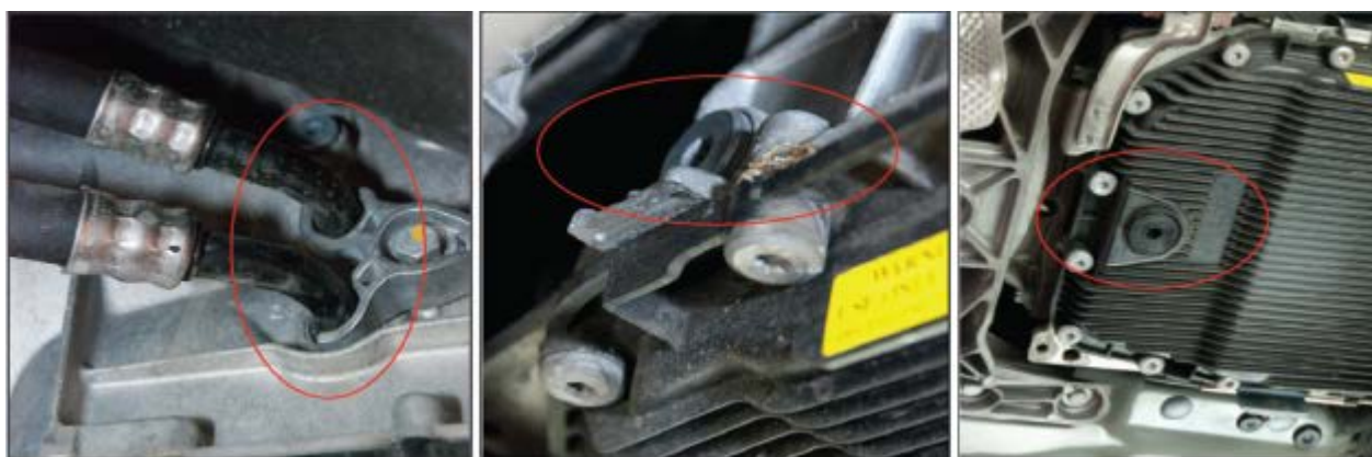
Рис 17 – Трубки подачи и слива, индикатор уровня, сливная пробка
