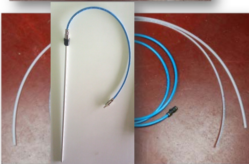
Рис 14 – Трубки для слива масла
