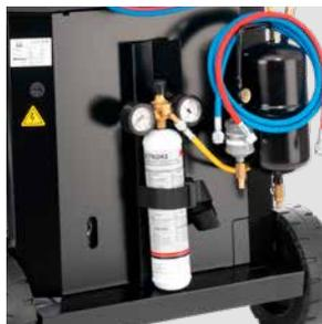
Широкий спектр принадлежностей, которые поставляются отдельно или устанавливаются на заводе. Комплект для работы с азотом / индикаторным газом; промывочный комплект, который позволяет сделать установку ACS полнофункциональной станцией для диагностики и ремонта систем кондиционирования.
