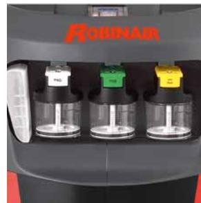
Исключается опасность взаимного загрязнения масел PAG и POE благодаря независимой системе впрыска масла, герметичным ёмкостям и циклу промывки сервисных шлангов, который автоматически запускается при каждой смене типа масла.
