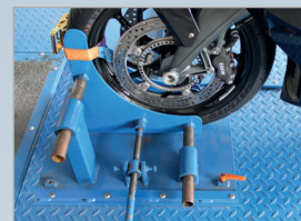
Механическое зажимное устройство для фиксации колеса
