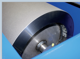
Ролик агрегата с Ni/Cr покрытием
