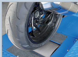
Инерционный монороликовый стелд обеспечивает оптимальное сцепление и снижает нагрев шины
