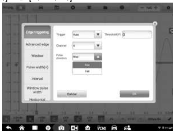
Рисунок 7-68. Пример окна настройки направления импульса
