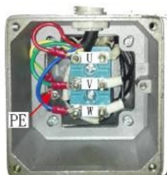
Рис. 12-5 Подсоединение проводки к терминалу мотора
