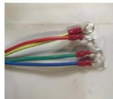
Рис. 12-6 Цвета проводников: красный (U), синий (W), зелёный (V), провод заземления – жёлтый (PE).
