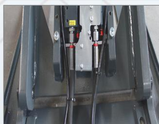
Перемещение обеих пар цилиндров отслеживается с помощью тросового потенциометра; управление гидравлической синхронизацией производится полностью автоматически. Благодаря этому, оператору не требуется производить выравнивание платформ вручную.
