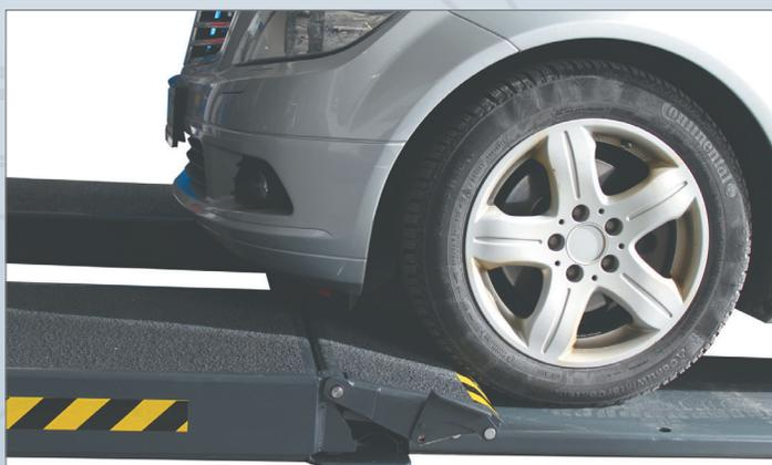
... благодаря которым обеспечивается свободный въезд на подъемник автомобилей с малым дорожным просветом.
