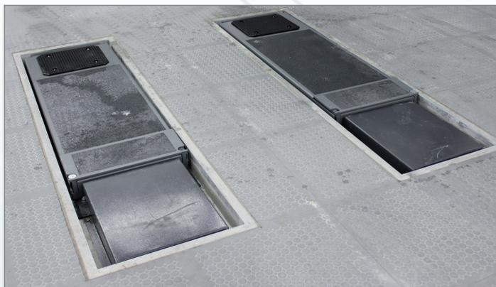
Подъемник TWIN F IV 3.0/3.5 U может быть опущен, даже когда платформы полностью раздвинуты. Это стало возможным благодаря фундаментным выравнивающим рамам, которые входят в стандартный комплект поставки подъемников этой модели.
