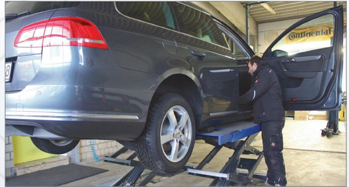
Когда автомобиль вывешен на подъемнике, его двери можно открыть полностью. Это обеспечивает комфортную работу.
