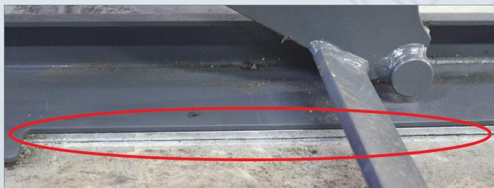
Фундаментная рама имеет гальванопокрытие для увеличения срока службы подъемника и защиты его от коррозии. Входит в стандартный комплект поставки подъемника TWIN F IV 3.0/3.5 U.
