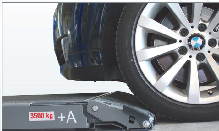
Небольшая въездная высота подъемника при напольном монтаже - всего 105 мм
