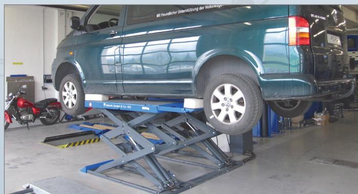
Большие пределы раздвижения платформ - от 1550 до 2100 мм - делают возможным подъем как небольших автомобилей, так и длиннобазных микроавтобусов.
