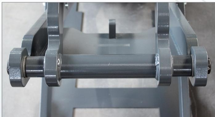
Высокая поперечная стабильность достигается благодаря специальному профилю ножиц подъемника
