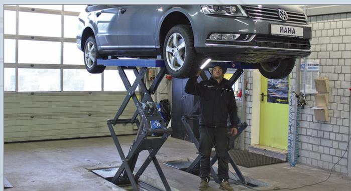
Комфортную работу с автомобилем обеспечивает большая высота подъема даже при монтаже вровень с полом.
