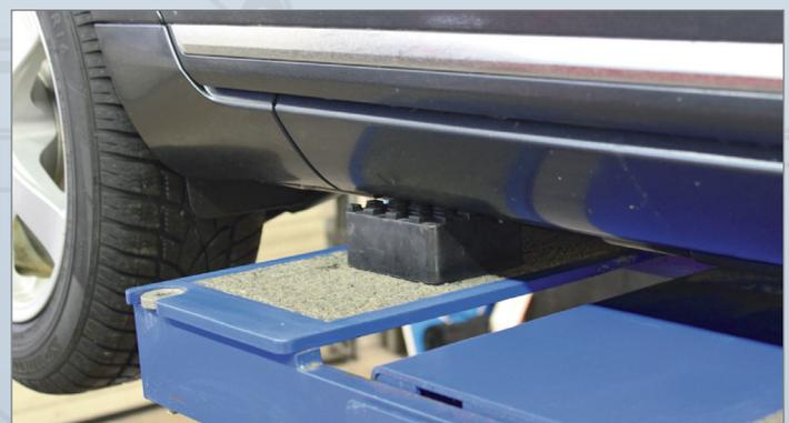
Гранулированное покрытие платформ и въездных рам обеспечивает хорошее сцепление с колесами автомобиля и дополнительную надежность при подъеме автомобиля с использованием подставок.
