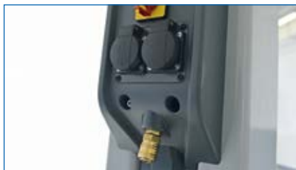
Энергоблок для панели управления: 2 разъема для подключения электропитания 220 В 1 штуцер сжатого воздуха
