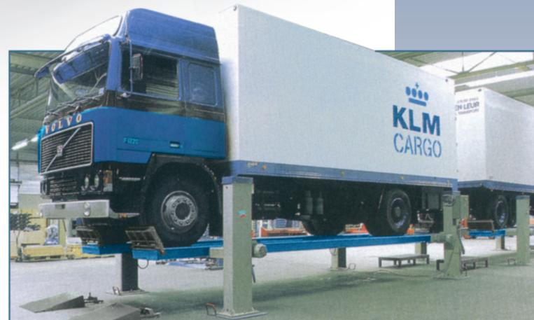
Двигатели подъемника взаимосвязаны механически, посредством трансмиссионных валов и конических редукторов, расположенных в масляной ванне. Это обеспечивает идеальный горизонтальный уровень платформ, а также равномерную нагрузку на двигатели, независимо от расположения на нем транспортного средства. Подъемник не требует дополнительной регулировки после установки, благодаря отсутствию деталей, подлежащих деформации или растяжению, как цепи и тросы.
