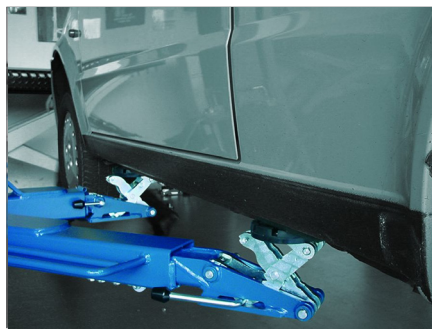
MINI-MAX: удобный подхват под низкие пороги
