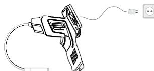
После полной зарядки Вы можете продолжать использовать устройство до 4 часов. Если батарея разряжена, на дисплее появится сообщение «Low Battery». Затем необходимо подключить адаптер питания к устройству и к розетке для зарядки батареи. Пожалуйста, используйте USB зарядное устройство 5В 1А для зарядки устройства. **Не используйте зарядное устройство 12В**
