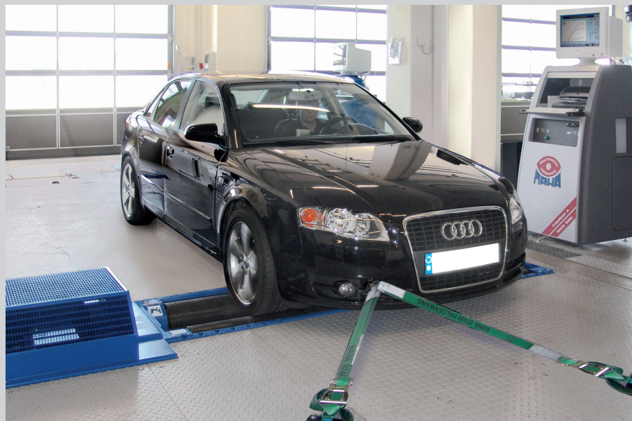
Фиксация автомобиля удерживающими ремнями
