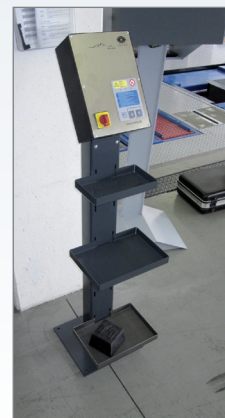
Пульт управления на многофункциональной стойке, можно разместить в любом удобном месте
