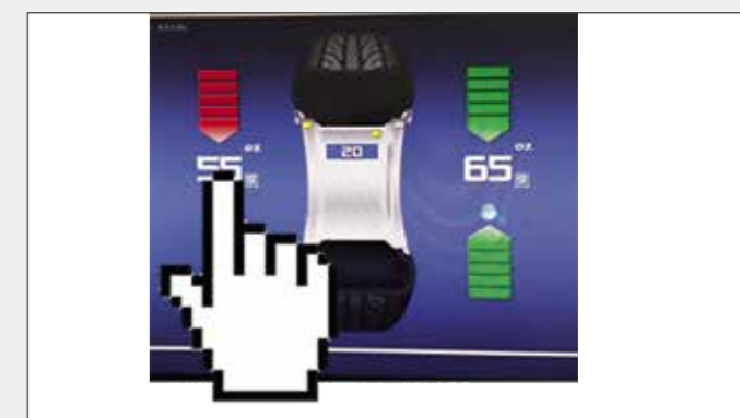
Функция Stop-in-Position Оператору нужно только коснуться указателя массы груза на экране, и колесо автоматически поворачивается в положение уравнивания.
