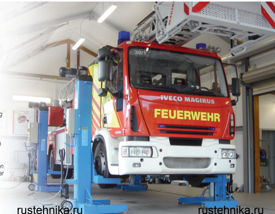
Модульная электрическая система позволяет формировать различные конфигурации (переход от 4 к 6 колоннам или 8-ми, или создание двух модулей по 4 колонны, разделив блок из 8).
