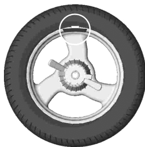
Рисунок 6.6 - Груз установлен в «12 часов»
