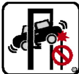
**НЕ СТАВЬТЕ ПОД АВТОМОБИЛЬ НИКАКИХ СТОЕК, ЕСЛИ ВАМ НУЖНО СНЯТЬ КАКУЮ-ЛИБО ДЕТАЛЬ С ПОДНЯТОГО АВТОМОБИЛЯ – ОПУСТИТЕ ЕГО.**
