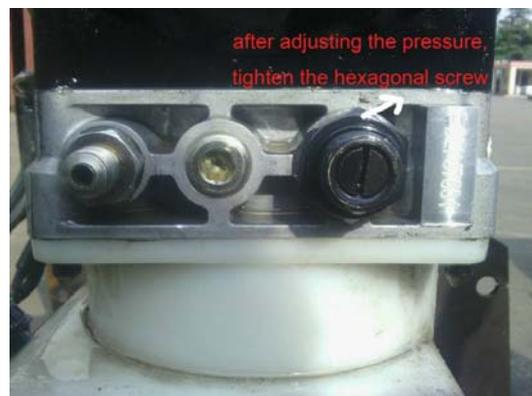
4) После регулировки давления затяните черную контргайку.
