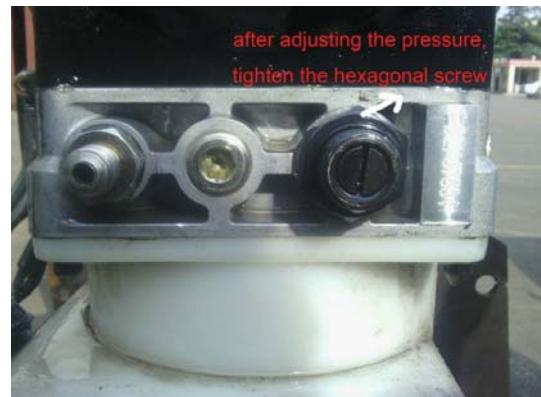
4) После регулировки давления затяните черную контргайку.
