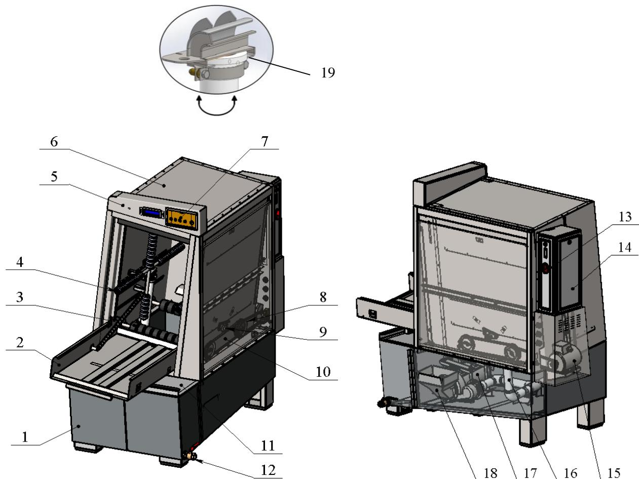
1 – ванна, 2 – дверца, 3 – приводной вал, 4 – боковой ограничитель, 5 — корпус системы управления, 6 – корпус моечного отделения, 7 — кнопочная панель, 8 – ременная передача, 9 – ролик натяжной, 10 – съемная панель, 11 – люк для чистки ванны, 12 – кран, 13 – общий выключатель напряжения, 14 – шкаф с автоматикой, 15 – эл. двигатель привода колеса, 16 – система подачи воды, 17 – насос, 18 – приемная воронка, 19 – распылитель.
