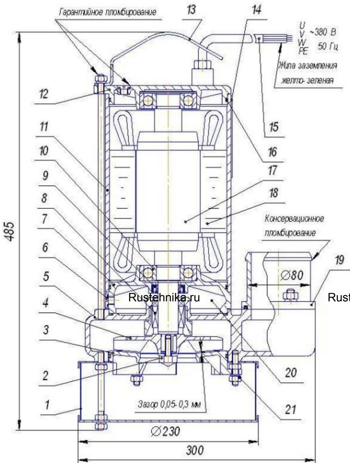
1-фильтр, 2-болт, 3-диафрагма, 4-колесо рабочее, 5-корпус насоса, 6-пробка,
