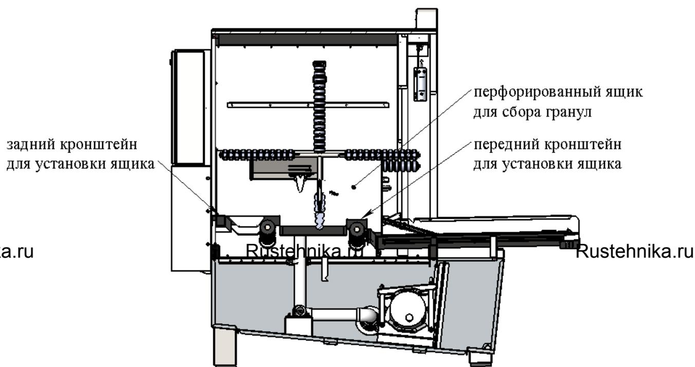
Рис.7. Установка ящика для сбора гранул.
