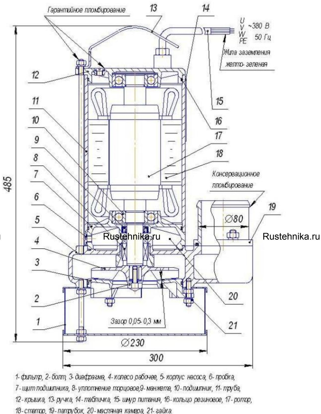
Рис. 10. Устройство электронасоса.
