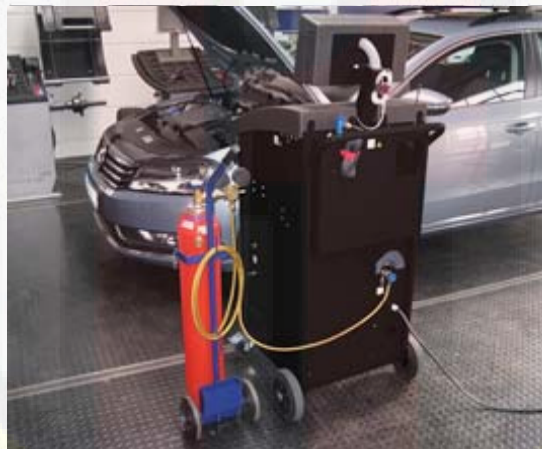
Подключение баллона с газом
