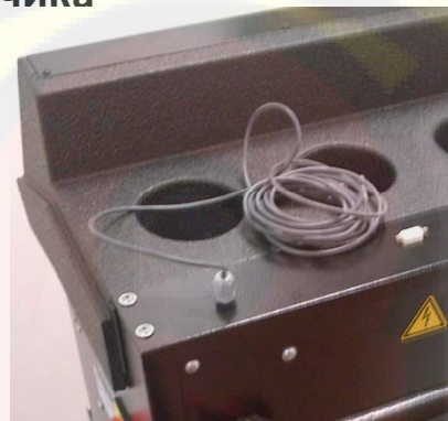
Опциональный проводной датчик с кабелем 5м
