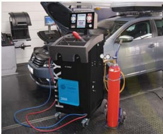
Поиск утечек с помощью трассировочного газа
