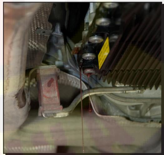
**Рекомендации:** в данном случае свидетельством корректного уровня предварительного наполнения будет выход жидкости из отверстия регулятора уровня масла. Если типом трансмиссии не предусмотрено такое визуальное наблюдение, необходимо определить количество предварительного наполнения, необходимого для данного типа трансмиссии.
