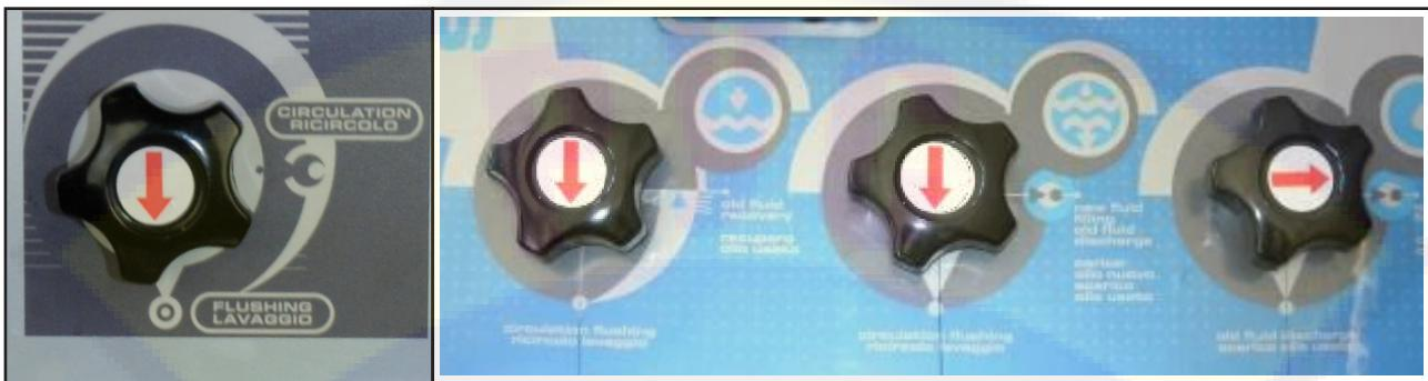
е) Включить электродвигатель и с помощью рычага трансмиссии выбирать все передачи по очереди, чтобы обеспечить открытие всех электроклапанов, а также омывание аддитивом всех органов трансмиссии. С помощью манометров можно увидеть давление при работе различных передач. Иногда можно столкнуться с небольшим увеличением вследствие промывки: это следует считать корректирующим коэффициентом чистоты.
