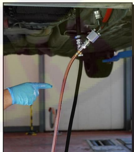
е) необходимо завести электродвигатель и проверить, чтобы поток масла циркулировал от станции ATF по направлению к трансмиссии (снизу вверх). Немедленно после проверки выключить электродвигатель.
