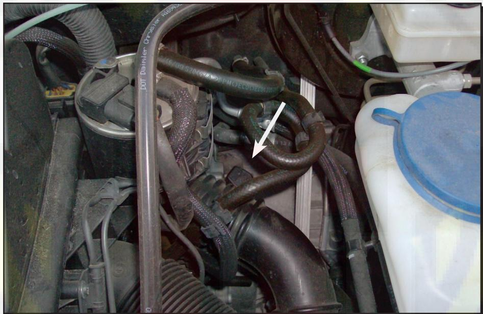
Для выполнения операций по сливу масла из маслосборника, вновь подсоединить специальную трубку, поставляемую в комплекте, сбоку станции заливки, к входу стержня для измерения уровня масла, а другой конец вставить в трансмиссию до упора, как показано на рисунке.
