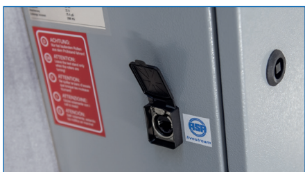
ASA Livestream (внешний интерфейс данных, например, для точки доступа к wi-fi)
