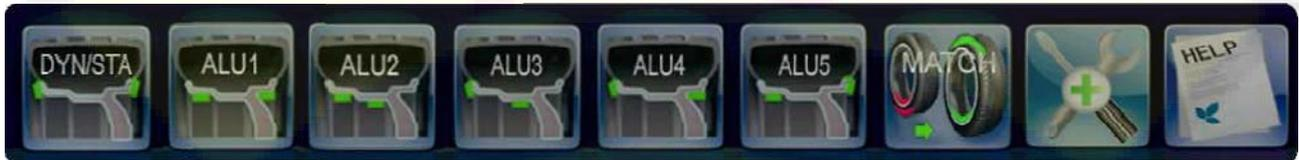
Балансировочный станок работает в режимах статической и динамической балансировки, а также балансировки алюминиевых дисков 1-5 ALU, и режимах OPT (оптимизация веса балансировочного грузика) и SPLIT («расщепление» балансировочных грузиков).
