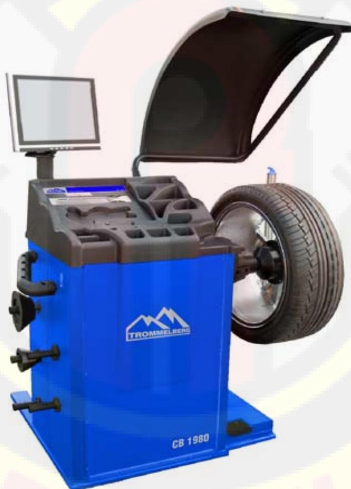
Балансировочный станок СВ1980 со стандартным жидкокристаллическим дисплеем для балансировки стальных и алюминиевых дисков легковых автомобилей и легких грузовиков. Станок работает в режимах статической и динамической балансировки, имеет 5 режимов балансировки алюминиевых дисков, а также режимы OPT и SPLIT. Оснащение станка позволяет автоматически вводить размеры колеса, измерять значения вылета и диаметра при помощи лазерного указателя.
