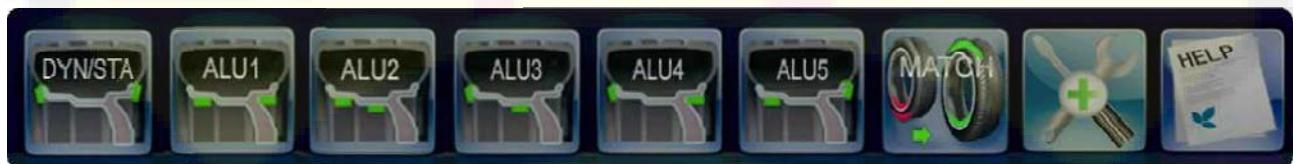
Балансировочный станок работает в режимах статической и динамической балансировки, а также балансировки алюминиевых дисков 1-5 ALU, и режимах OPT (оптимизация веса балансировочного грузика) и SPLIT («расщепление» балансировочных грузиков).
