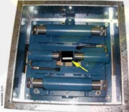
См. стрелку = положение распорки (например, деревянной колодки шириной пр. 100-130 мм)
