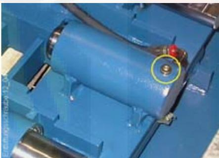
3. При помощи пульта управления на переносном светильнике выдвинуть соответствующий цилиндр и держать кнопку нажатой. **ВНИМАНИЕ! Опасность заземления в кассете!!!**
