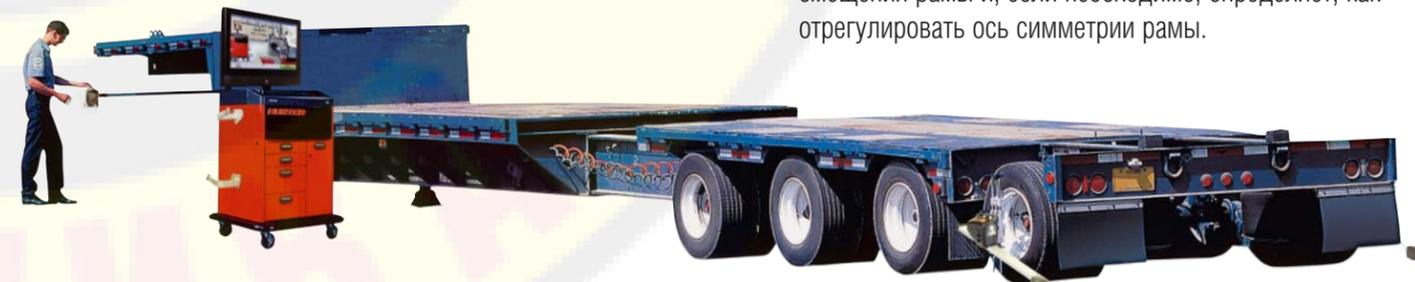
WinAlign HD поддерживает широчайшую базу данных конфигураций осей, позволяя измерять развал схождение с помощью беспроводных датчиков на расстоянии между передними и задними до 15 м. Программное обеспечение позволяет выбирать режимы регулировок грузовиков, автобусов, автопоездов и прицепов.
