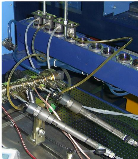
Подключите провода от гнезд 1 – 6 на передней панели станда к электрическим разъёмам CR форсунок.
