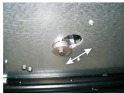
1. ОТКРУТИТЬ ВИНТ БЛОКИРУЮЩЕГО УДЛИНИТЕЛЯ ВЕСОВ.
