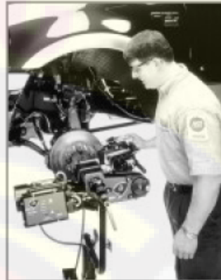
Техник устанавливает глубину резки
