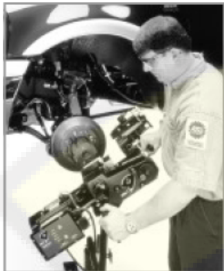
Шаг 2 Решения 4/9.0: техник устанавливает станок на адаптере.
