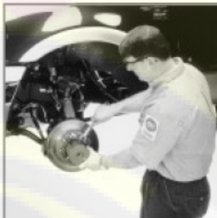
Шаг 1 Решения 4/9.0: техник устанавливает адаптер на ступице.
