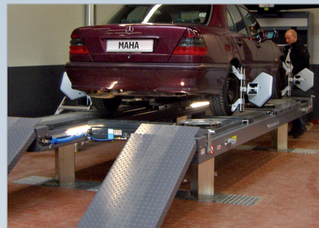
Высокая точность делает возможным использование данного подъемника на постах РУУК
