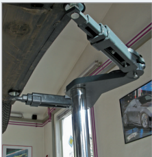
Телескопические рычаги с большой областью подхвата.
