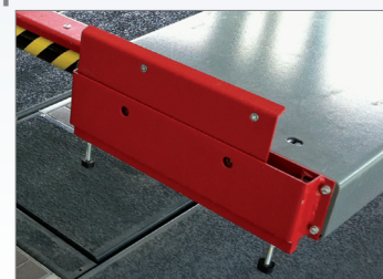
Автоматический противооткатный упор
