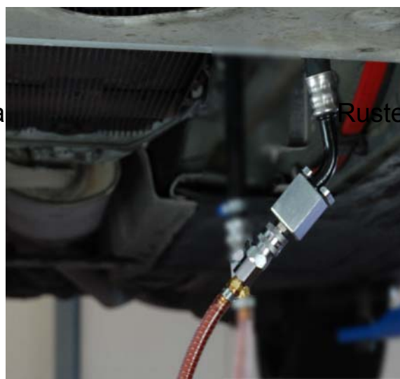
Рис. 17b – подключение шланга давления (в данном случае он подключается к шлангу, который идет от коробки передач к радиатору)
