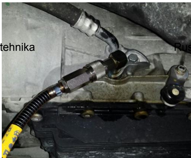
Рис. 17a – подключение шланга возврата (в данном случае прямо к коробке передач)
