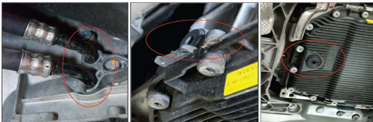
Рис. 14 – трубки подачи и возврата, индикатор уровня, сливная пробка
