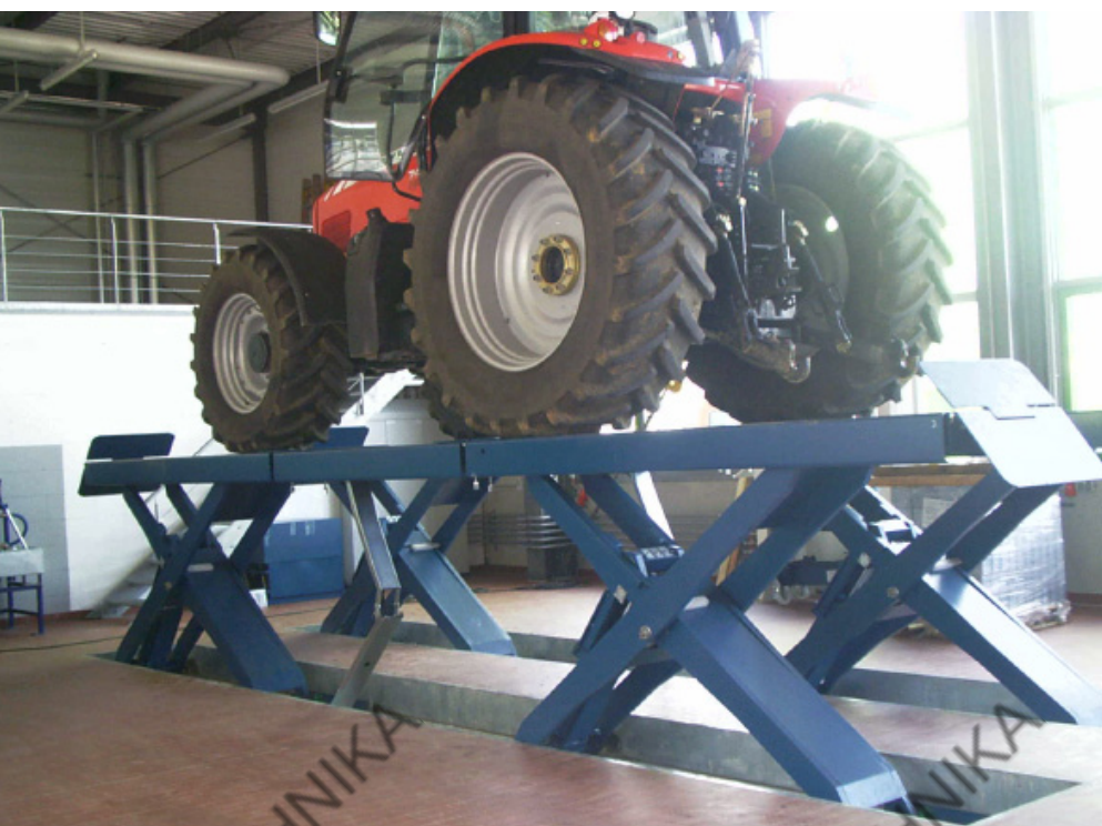
Модули подъемника могут управляться по отдельности.
