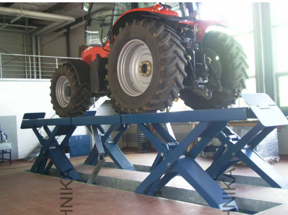
Модули подъемника могут управляться по отдельности.
