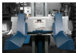
регулируемые вилочные захваты для колес от 12" до 22" с фиксатором
