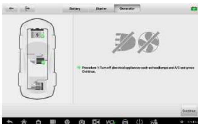
Рисунок 9-11. Пример окна проверки генератора переменного тока
