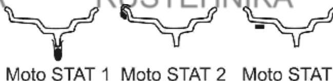
Рисунок 5.6 – Схемы установки грузов
