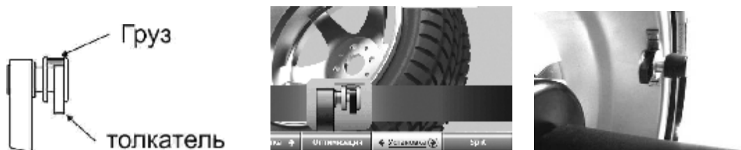
Рисунок 5.13 – Установка груза линейкой
