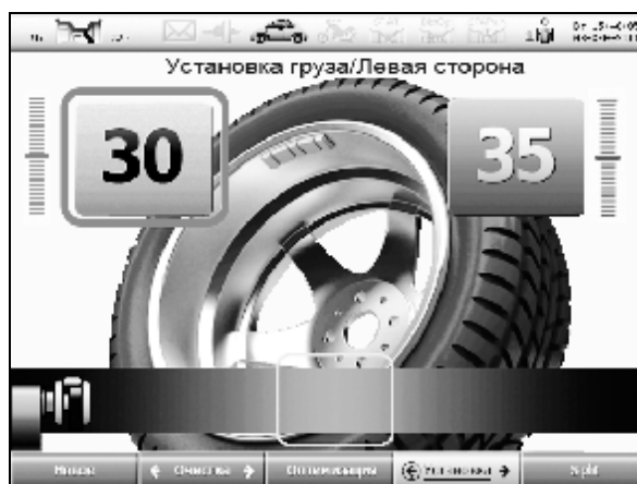
Рисунок 5.12 – Экран при установке груза линейкой
