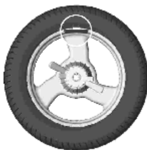
Рисунок 6.6 - Груз установлен в «12 часов»
