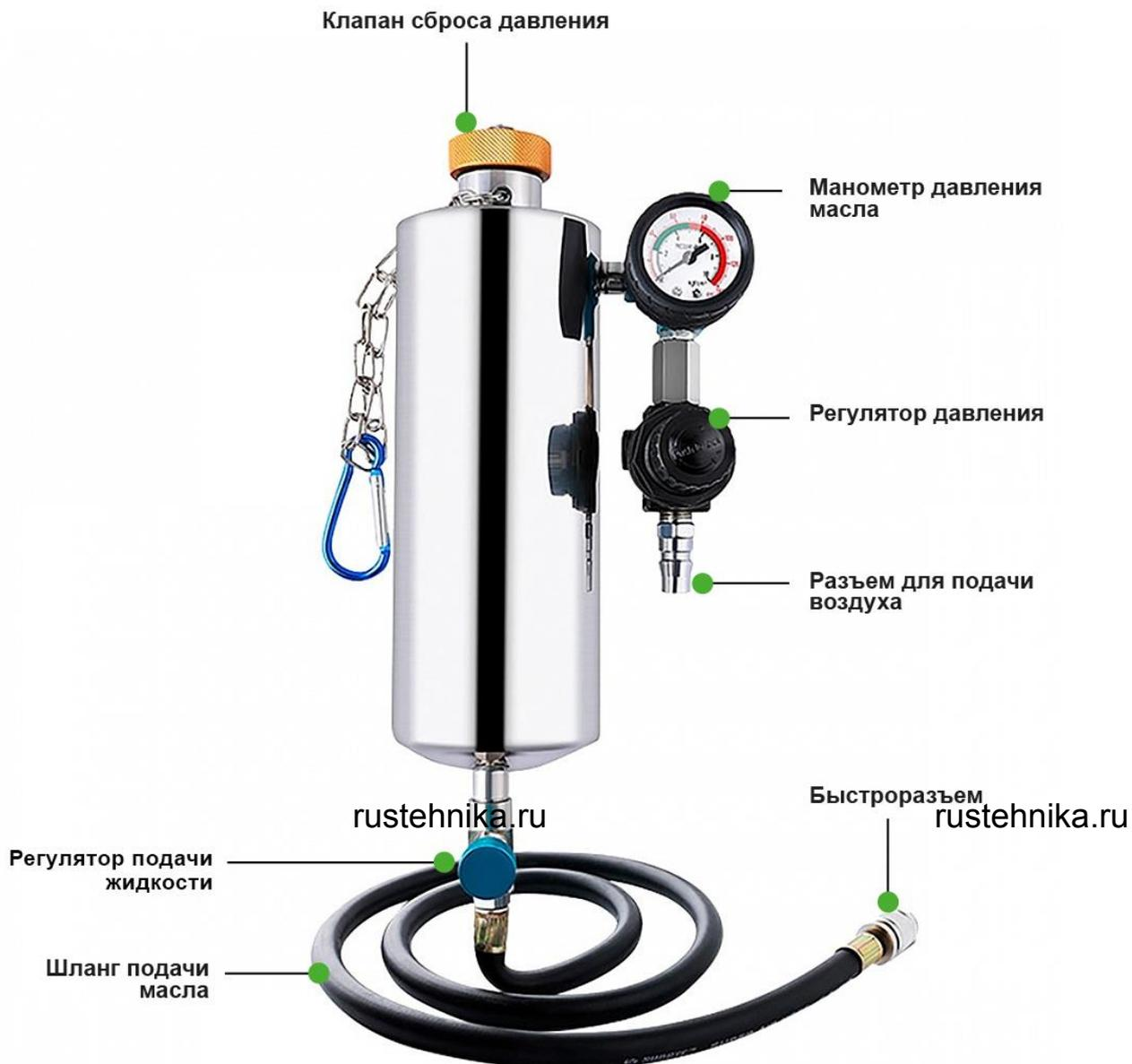
Рис.2 Устройство аппарата GX-100
