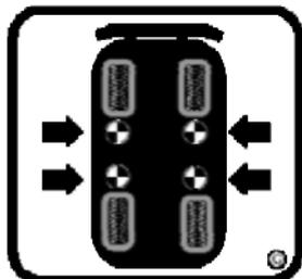
ИСПОЛЬЗУЙТЕ ТОЧКИ ПОДЪЕМА ТРАНСПОРТНОГО СРЕДСТВА, ОБОЗНАЧЕННЫЕ ПРОИЗВОДИТЕЛЕМ.
