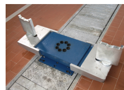
Для подхвата автомобиля существуют различные адаптеры
