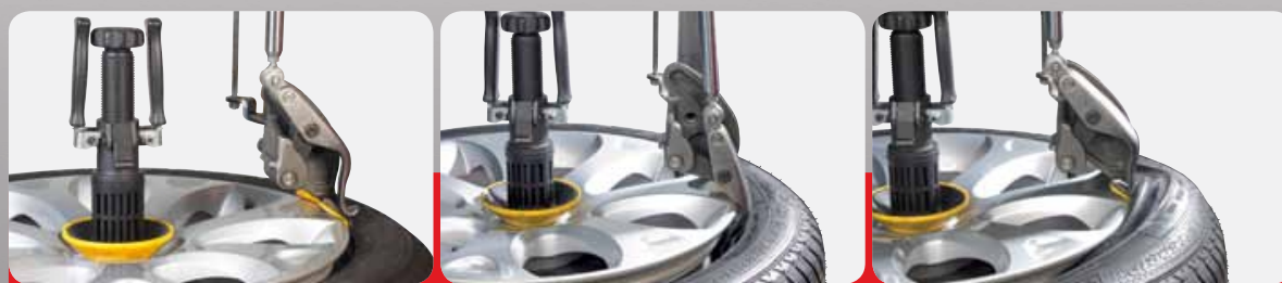
Процедура демонтажа борта покрышки
