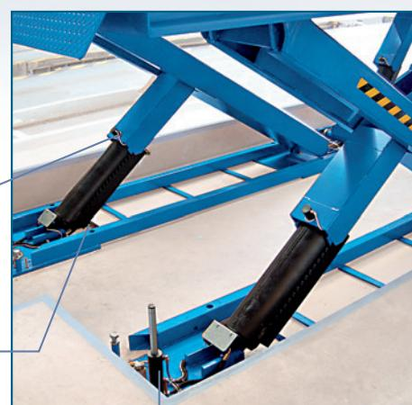
Гидравлическая синхронизация между платформами независимо от распределения нагрузки при помощи:
