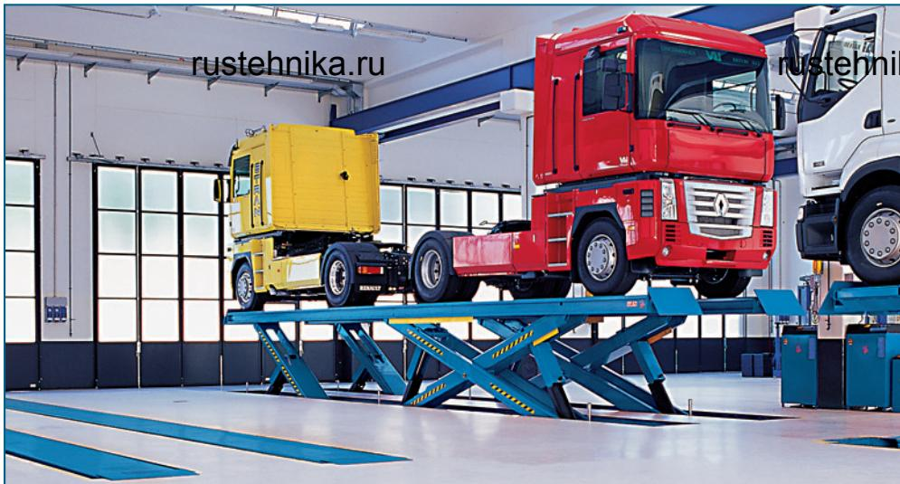
Le RAV745HD a été conçu pour des charges particulièrement élevées (HD=Heavy Duty). Grâce à sa structure composée d'un ciseaux et d'un lambda, ce modèle permet le levage de 45 tonnes, répartis sur seulement 9 mètres de chemins de roulement, c'est-à-dire sur des essieux rapprochés les uns des autres. Le RAV745 est quant à lui indiqué pour les véhicules articulés et des camions-remorques. La capacité importante permet le levage de véhicules à pleine charge.
