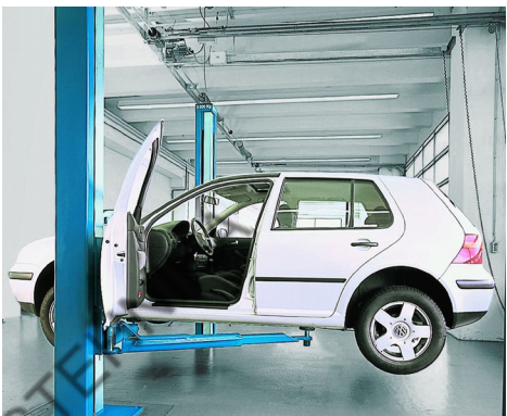
Ассиметричная конструкция позволяет свободно открывать двери
