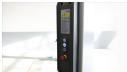
Дополнительная панель управления на второй стойке позволяет сократить путь перемещения вокруг подъемника.
