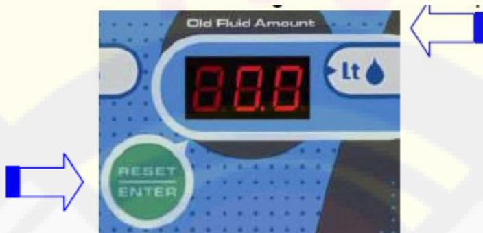
При помощи кнопок «Е» задайте количество масла, заправляемого в КПП; Сверьтесь с техническими характеристиками автомобиля и добавьте 1-2 литра для выполнения полного цикла;
