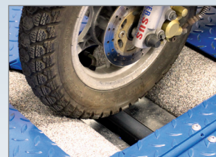
Роликовый агрегат оснащен пневматическим подъемником и тормозом
