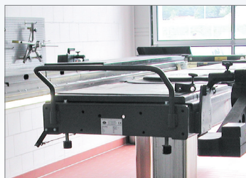
Стандартный упор U-образной формы
