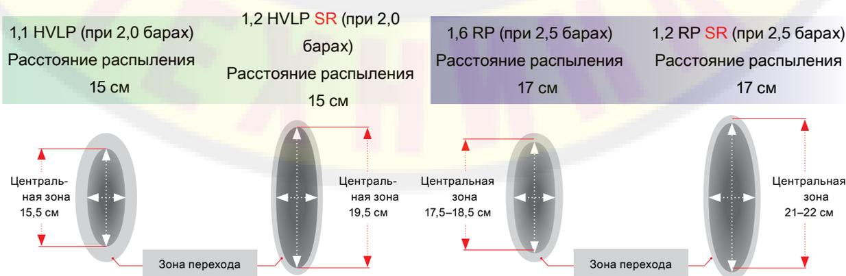
Стандартные сопла с влажными компактными центральными зонами. Сопла SR с расширенными центральными зонами.
