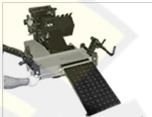
3. Выньте фиксатор из пневматического блока управления.
