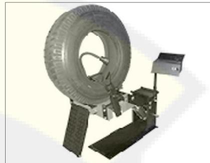
6. При необходимости установки шины в другое положение, пожалуйста, потяните вниз джойстик клапана управления высотой платформы, установите шину в правильное положение на устройстве, предварительно ослабив захват. После этого выполните необходимые работы.
