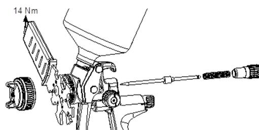
Spritzstrahl einstellen / Adjust spray fan pattern
