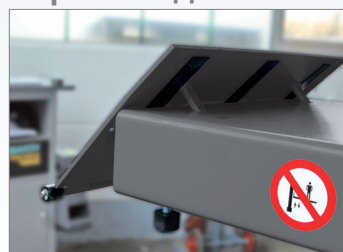
Въездные ramпы при монтаже подъемника вровень с полом
