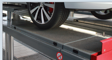
Платформы с выравнивающими пластинами для подъемника второго уровня и плекта для РУУК. Rustehnika.ru
