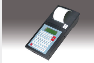
Ручной радиотерминал с ЖК-дисплеем и ленточным принтером
