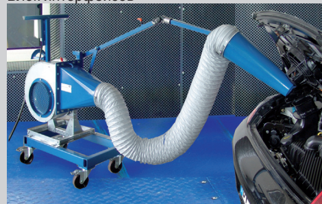
Дополнительный охлаждающий вентилятор для агрегатов автомобиля
