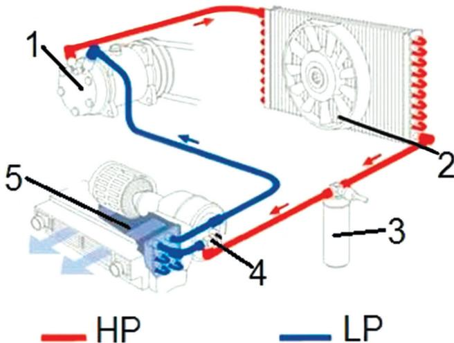
Рис. 5. MS101P – Схема автомобильной системы кондиционирования
