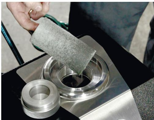
**Рис. 6. Фильтрующий элемент после первого цикла промывки**
