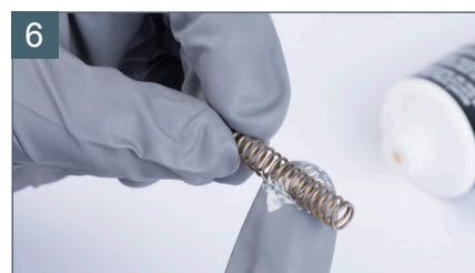
Смажьте и вставьте пружину окрасочной иглы
