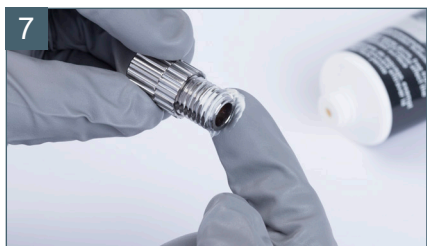
Смажьте резьбу винта-регулятора подачи материала
