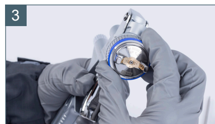
Установите воздушную головку
