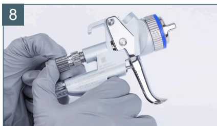
Установите винт-регулятор подачи материала
