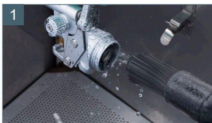
1 Очистите канал для подачи материала
