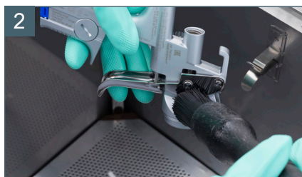
2 Очистите корпус окрасочного пистолета
