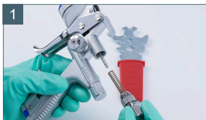
1 Сначала отсоедините окрасочную иглу.
